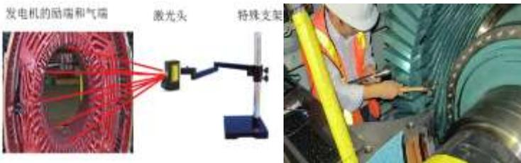
发电机励端/气端的模态测试
