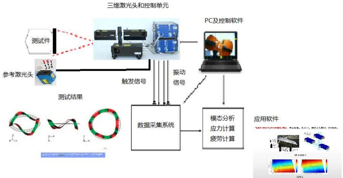
三维扫描激光测振仪系统
