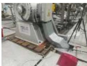
测功机壳体振动和转轴振动测试
