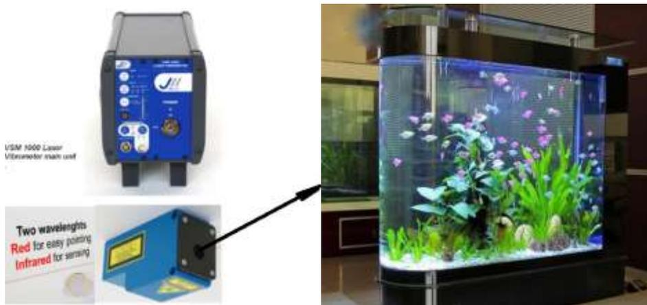
南京维提思的水下振动激光测振仪 VSM1000-UW 采用波长为 780nm 的半导体激光，利用水或水混合物的对次波长的吸收率非常低，再和自混合干涉技术结合起来，可以完成从空气中对水中（分水厚度为 0-50cm 或 0-200cm）运动物体表面的测量，并且通过软件，自动修正测量结果，从而能测量出水中物体表面的微小振动。
