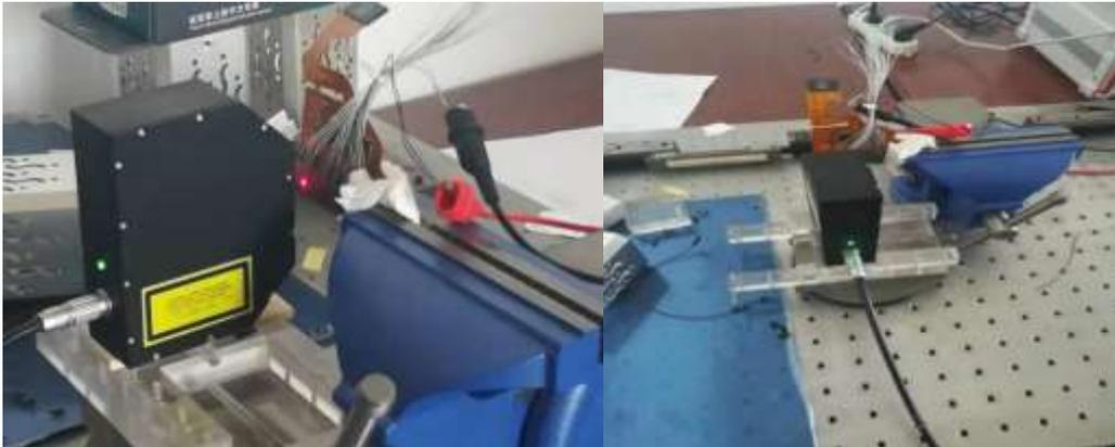
测试目标：陶瓷片高频振动测试
