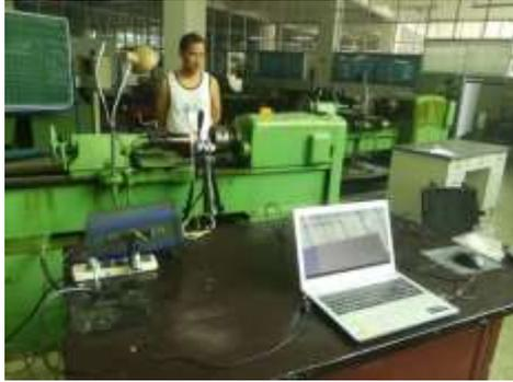
机床转轴的振动测试
